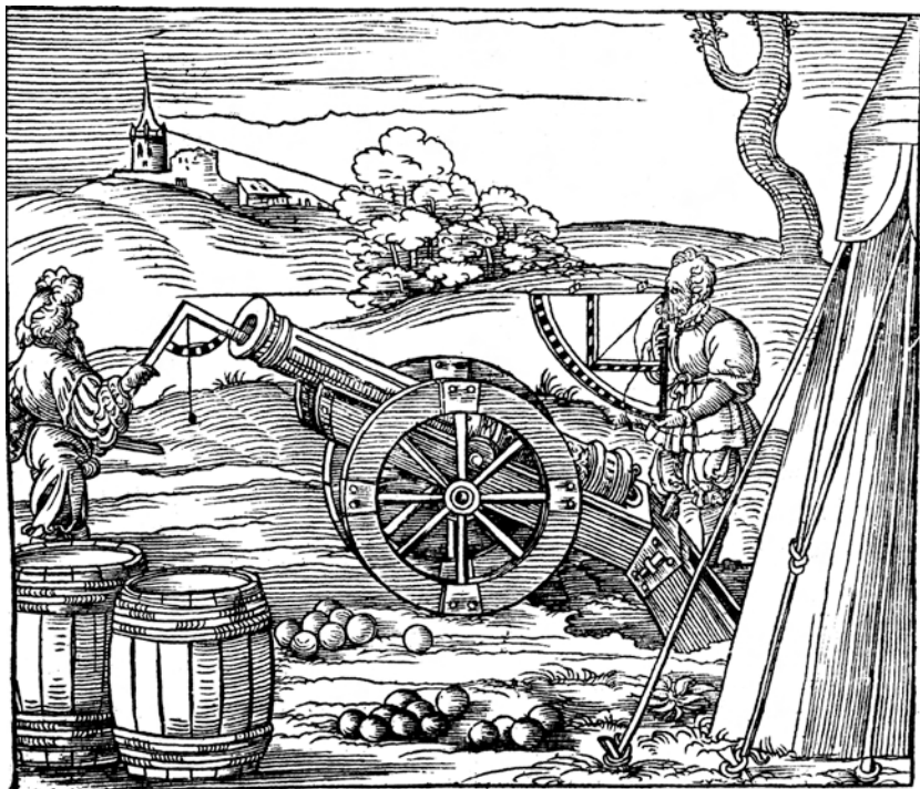
Наведение на цель пушки с применением квадранта из книги «Erste deutsche Vitruvausgabe»
